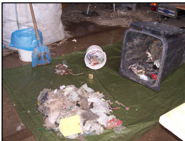
Abbildung 3 Sortierung der Fraktion ferromagnetisch > 80 mm
